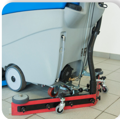
lo squeegee oscillante segue il movimento della macchina
