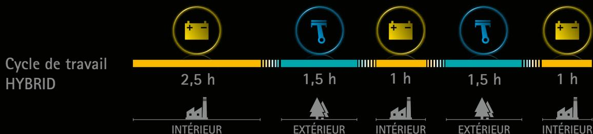
Grâce au système d'alimentation combinée Hybrid, la FSR peut être utilisée aussi bien à l'intérieur qu'à l'extérieur. Cette solution permet de choisir l'alimentation à essence pour les espaces extérieurs ou le silence et l'absence d'émissions du moteur électrique dans les espaces intérieurs.
