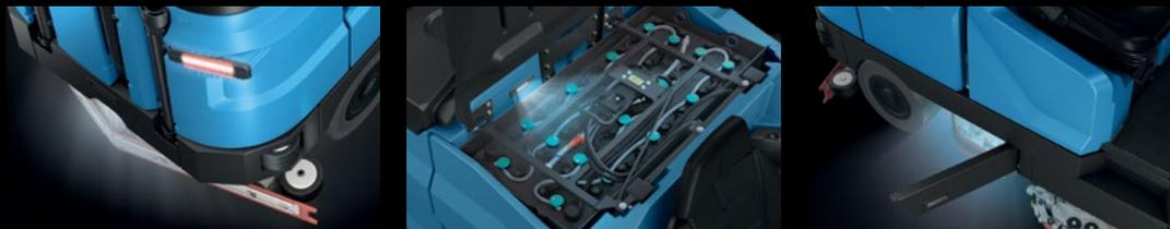
Les éclairages lumineux de service, augmente la visibilité des zones où les points de contrôles de l'opérateur ou du technicien sont nécessaires, grâce à un système de feux LED placés sous la machine
